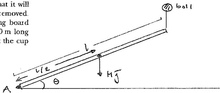
Hur stor är  $\theta$  högst vara för att bollen ska falla längsammare än änden på plankan?
