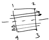
$$\oint \vec{B} \cdot d\vec{s} = \int_1^2 \vec{B} \cdot d\vec{s} + \int_2^3 \vec{B} \cdot d\vec{s} + \int_3^4 \vec{B} \cdot d\vec{s} + \int_4^1 \vec{B} \cdot d\vec{s}$$
