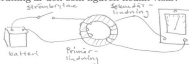
Ena delen (primärlindningen) av uppställningen består av ett batteri, en strömbrytare och en spole som är lindad runt en järnring. Den andra delen (sekundärlindningen) består av en spole och en amperemeter.
